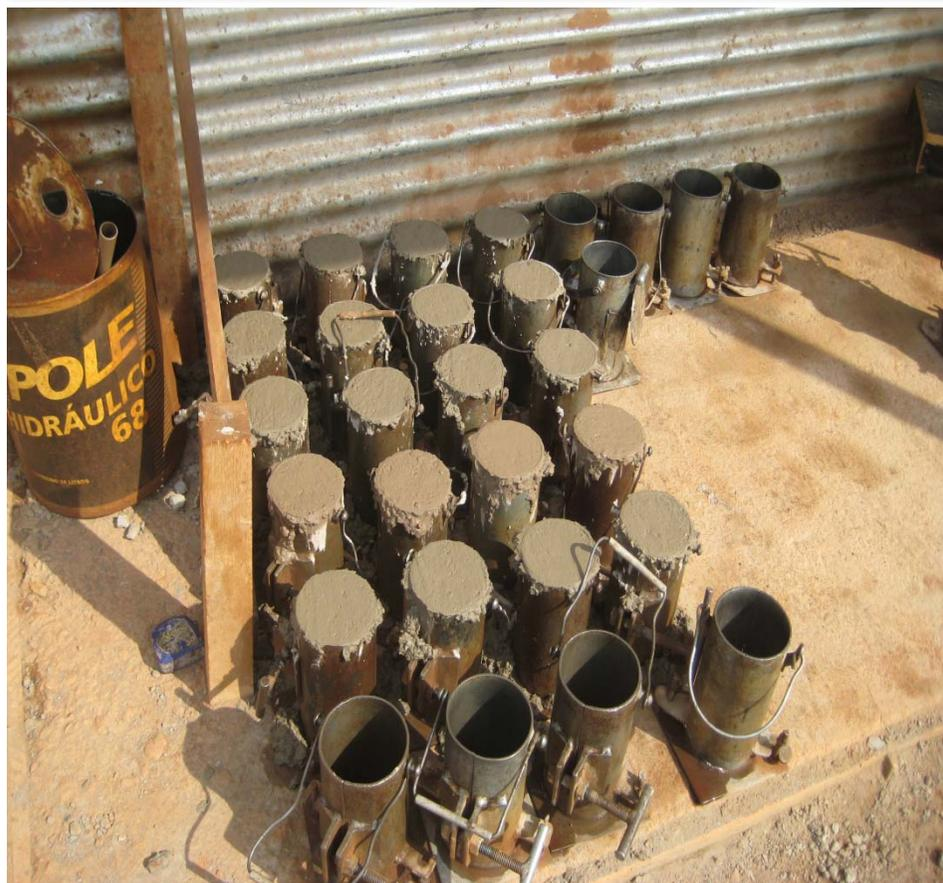
Foto 18 – Ensaio – Moldagem de corpos de prova
